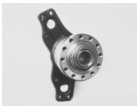
Limpe as superfícies de contacto das peças antes de voltar a montar.
