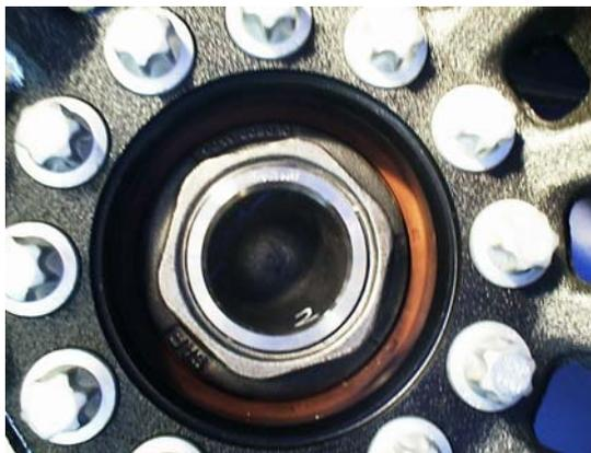
Identificação do número de série do eixo sem a placa de identificação: no topo do eixo e no sentido de rotação da marcha, está o número de série composto por 9 dígitos.
