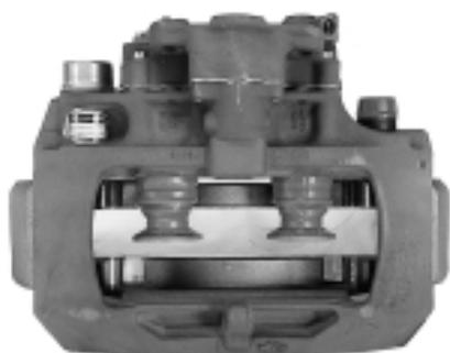
Inspeccionar os movimentos da pinça de travão a nível de guias e empurradores.
