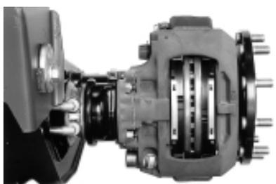
Desafinar a pinça de travão no afinador automático com auxílio de uma chave hexagonal, na direcção contrária à dos ponteiros do relógio, cerca de 2 a 3 cliks.
