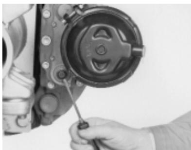
Remover a tampa de protecção da caixa do hexágono do afinador automático
