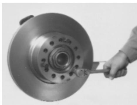
Soltar o disco de travão do cubo com o auxílio de parafusos M12x 1,5x 30.
