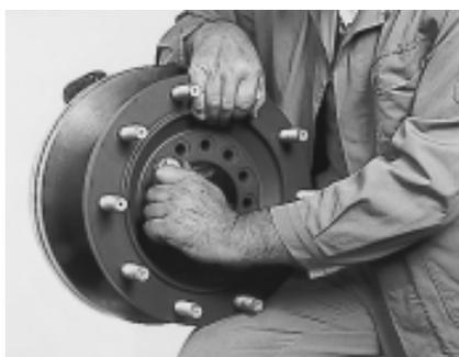
Montar o disco de travão e a flange de roda no cubo.
