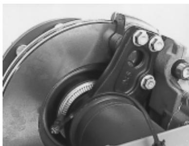
Desmontar o cilindro de travagem.
